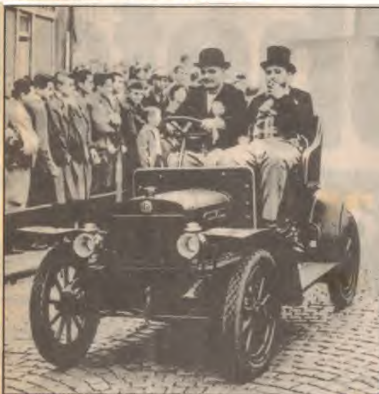
Der „Voiturette Modell A“ von 1905 (gr. Foto) hatte 2 Zylinder, schaffte mit 7 PS 40 km/h. Heute gibt's nur noch drei Exemplare in der CSFR.
