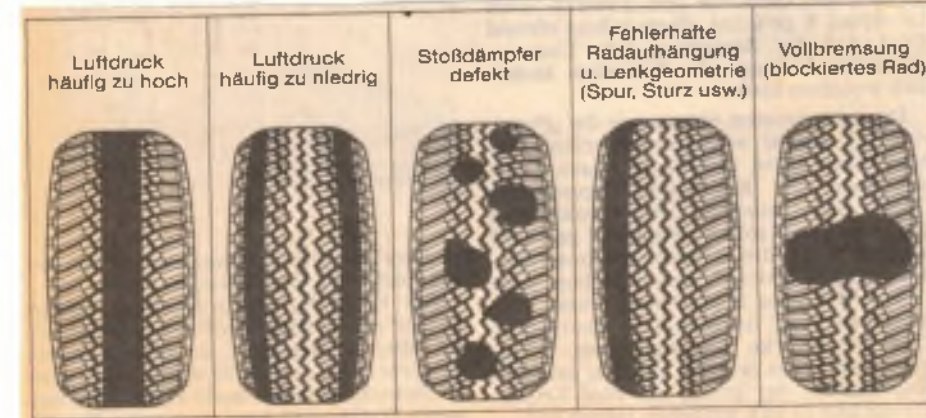
Unterschiedliche Ursachen von Schäden am Profil.
