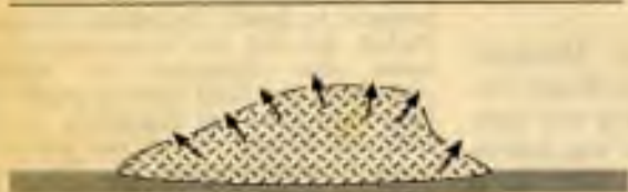
Gasaustritt vor der Sanierung
