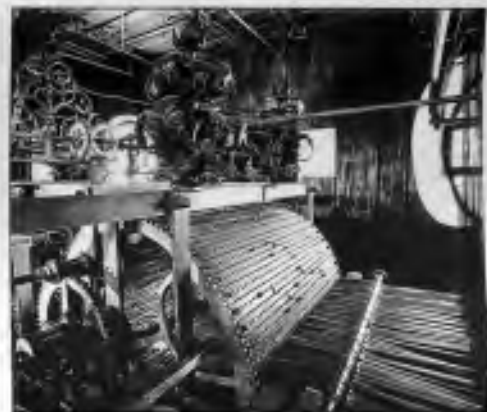
Hodinový stroj a válec s výstupky, který každou hodinu uvádí do pohybu mechanismus Loretánské zvonohry hrající Mariánskou píseň Tisíckrát pozdravujem Tebe .
