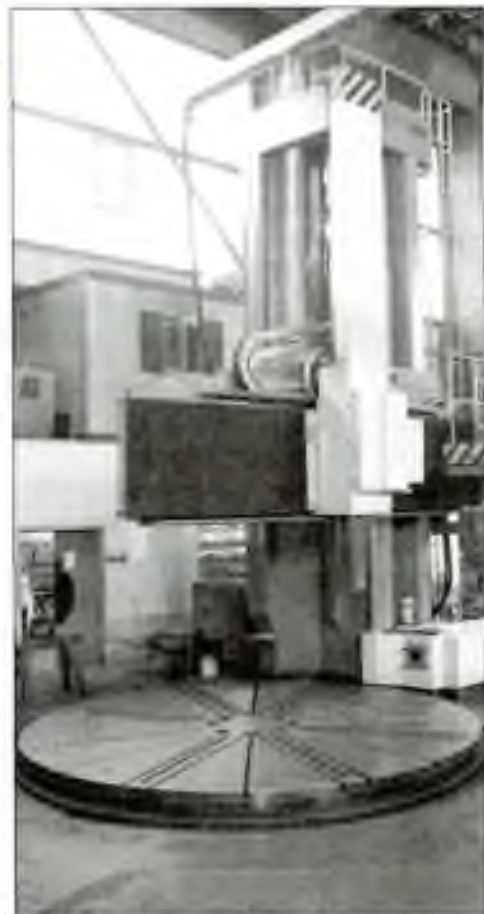
Svislý soustruh tzv. karusel vyrobený v ČKD Blansko v roce 2006
